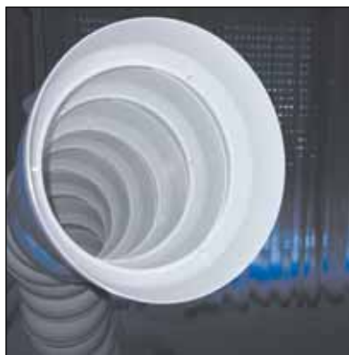
Εικόνα 4: Στόμιο φορητής συσκευής αναρρόφησης αερολύματος, μεγάλης διατομής.
