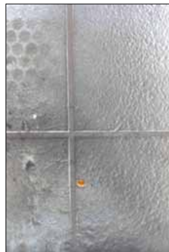
Εικόνα 5: Εξαιρετικά επιβαρυνόμενο πλέγμα φίλτρου συσκευής καθαρισμού αέρα.
