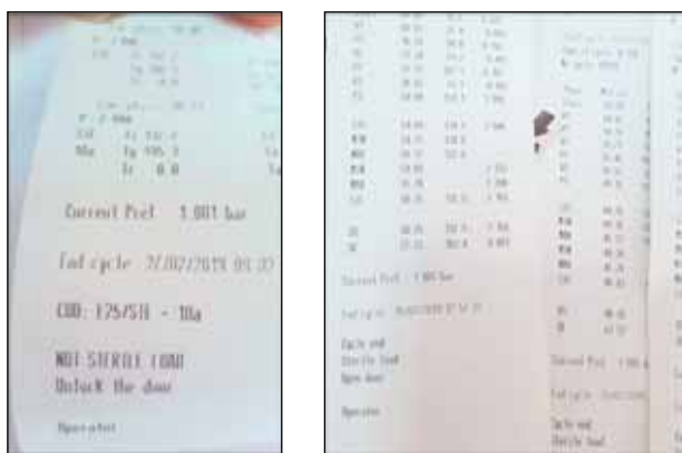
Εικόνα 2: Εκτύπωση σε θερμοευαίσθητο χαρτί της επιτυχούς (ΑΡ) και της ανεπιτυχούς (ΔΕ) πορείας του κύκλου αποστείρωσης.
