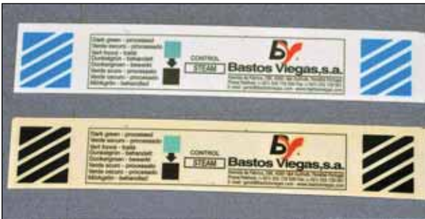
Εικόνα 9: Αλλαγή χρώματος στην επιφάνεια ταινίας.
