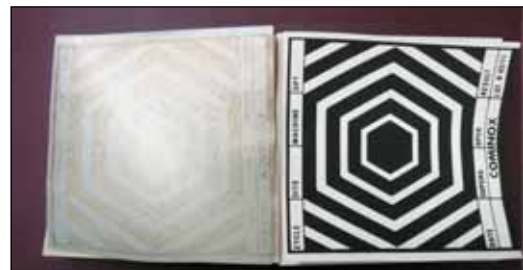
Εικόνα 14: Αλλαγή δείκτη σε πακέτο Bowie and Dick.
