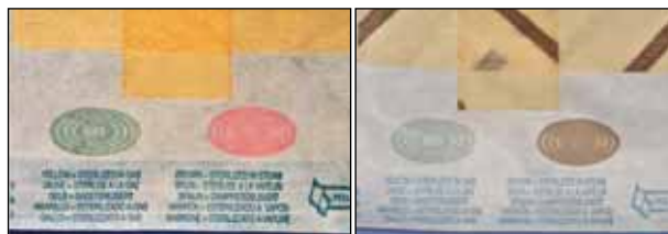
Εικόνα 5 και Εικόνα 6: Αλλαγή χρώματος εκτυπωμένων δεικτών στην επιφάνεια φακέλων
