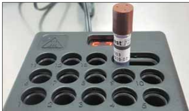
Εικόνα 21: Τοποθέτηση δείκτη στην ενεργοποιητική σχισμή.
