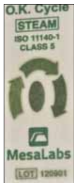
Εικόνα 15: Κυκλοτερής δείκτης Mesa Lab.
