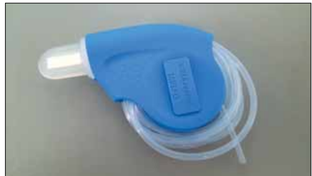
Εικόνα 17: Το σύστημα Helix κατάλληλο για τον έλεγχο της διεισδυτικότητας του ατμού σε κοίλα και σωληνωτά εργαλεία.
