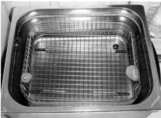
Εικ. 1: Λουτρό υπερήχων καθαρισμού εργαλείων.
