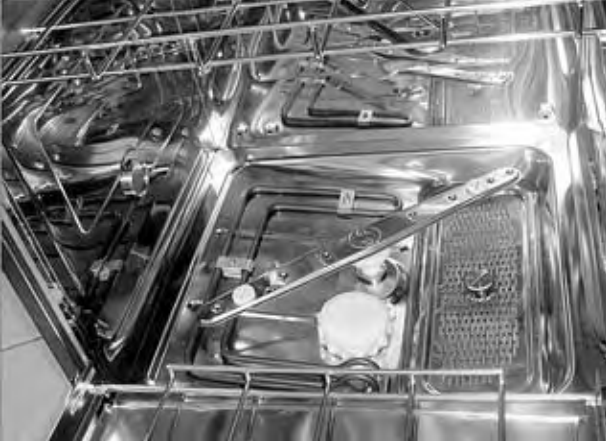
Εικ. 2: Εσωτερικό πλυντηρίου καθαρισμού εργαλείων.
